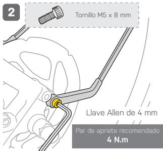
2 Instalar los soportes de las patas en ambos lados.
