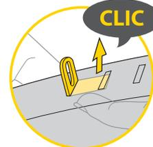
Cuando se haya confirmado la posición de montaje, instalar el adaptador en L en la posición adecuada.
