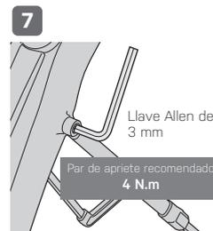
7 Apretar todos los tornillos cuando la instalación se haya completado.
