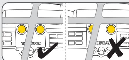
Quando si installa il Pannier DryBag DX sul portapacchi, assicuratevi che i ganci di fissaggio siano posizionati correttamente tra la metà della gamba del portapacchi, in modo che non si aprano accidentalmente.
