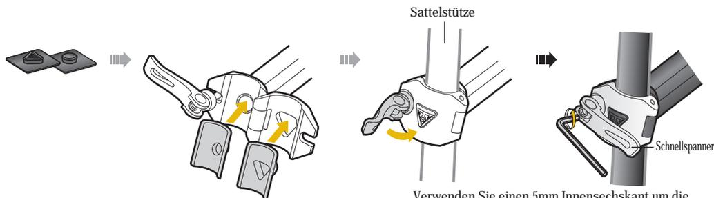
Verwenden Sie einen 5mm Innensechskant um die korrekte Spannung des Schnellspanners einzustellen. Eine stärkere Beladung des Gepäckträgers erfordert eine höhere Spannung, damit der Gepäckträger fest sitzt und nicht zur Seite pendelt.
